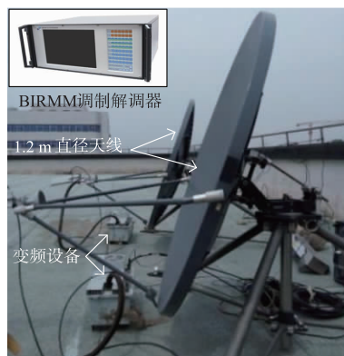
图11 系统试验室外设备(两个1.2m口径天线,两个变频设备,红色框图内设备为自研的BIRMM调制解调器)
